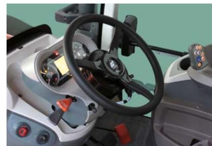
Das elektronische Lenkrad bietet nicht nur eine präzise Lenksteuerung, es ist auch eine hervorragende Alternative zu herkömmlichen Hydrauliklenksystemen.
