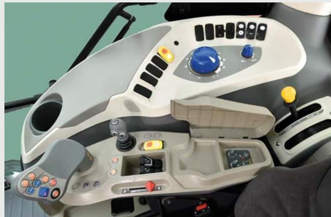
Kabineninterieur mit **VT-Drive** Getriebe: Die Bedienelemente sind in der rechten Armlehne des Fahrersitzes integriert.
