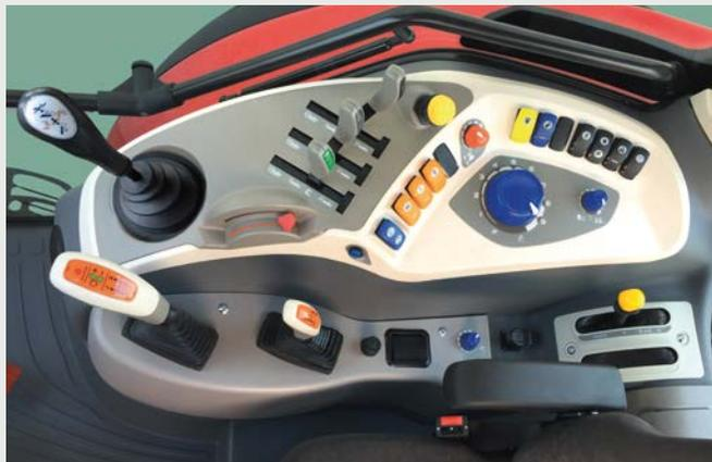
Kabineninterieur mit **Xtrashift** Getriebe: Die Bedienelemente befinden sich an der rechten Konsole.
