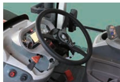
Le volant électronique permet un contrôle précis de la direction lors des travaux de plein champ avec un erreur maximum de 2 cm.
