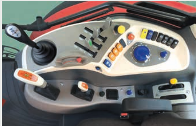
L'intérieur de la cabine dans la version Xtrashift : les commandes du tracteur sont intégrées dans la console à droite du conducteur.
