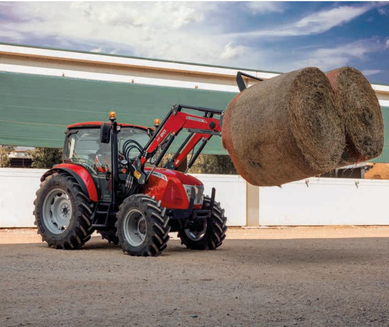
Der Frontlader McCormick M80 wurde für die einfache Anpassung in die Traktoren der Serie **X5** entwickelt und besteht aus HLE-Stahl (High Limit Elasticity), einem Material, das aufgrund seiner Eigenschaften hohen Belastungen standhält.
