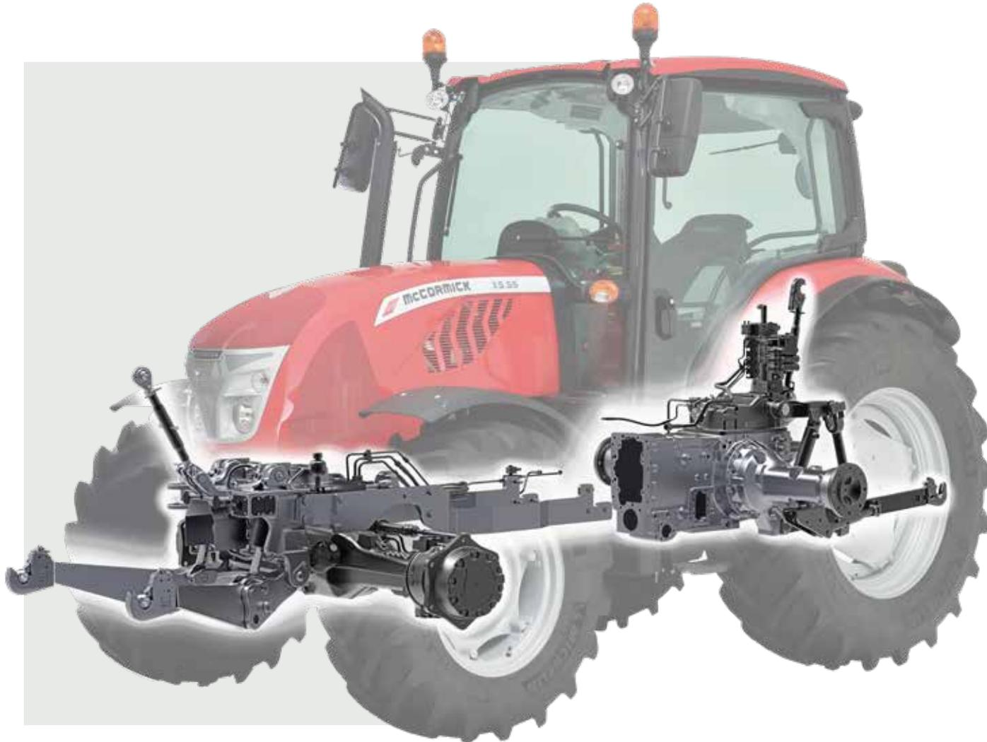
Die X5-Baureihe verfügt über ein Open-Center-Hydrauliksystem mit einer Fördermenge von insgesamt von 62 l/min, was den effizienten Betrieb aller Hydraulikfunktionen ermöglicht. Eine spezielle Pumpe versorgt das Lenksystem mit 32 l/min und sorgt für ein sanftes und präzises Wenden unter allen Bedingungen sowie für mehr Bedienkomfort und eine höhere Produktivität.
