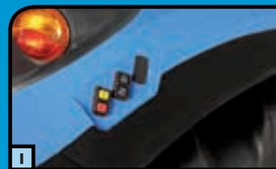
et de la prise de force sont disponibles aussi sur les garde-boue pour permettre l'accrochage et le décrochage des outils depuis le sol (fig. I).
