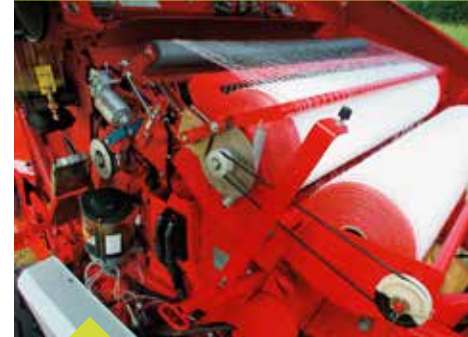
Le tube courbé étale le filet jusqu'au bord de la balle.
