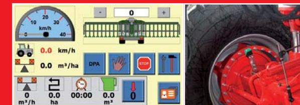
Le DPA (Débit Proportionnel à l'Avancement) agit sur l'ouverture de la vanne arrière pour réguler le débit en fonction de la vitesse et de la largeur d'épandage. L'opérateur renseigne les paramètres et le débit souhaité depuis l'écran tactile.
