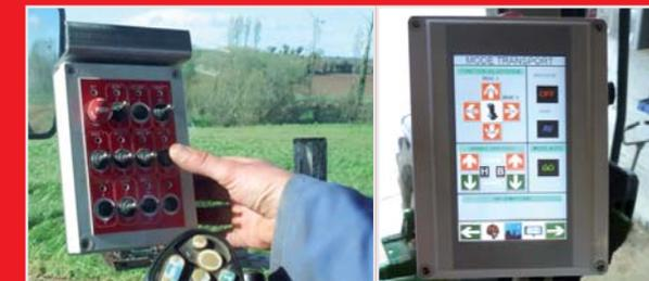
Le boîtier de commande ergonomique, disponible en mode filaire ou télécommande, centralise l'ensemble des commandes via un système BUS CAN évolutif. Découvrez aussi la force de la simplicité grâce à la commande intuitive par écran tactile. L'ensemble des cycles : transport, aspiration et épandage sont automatisés. Le mode manuel reste possible pour plus de polyvalence via l'écran et le joystick de commande.
