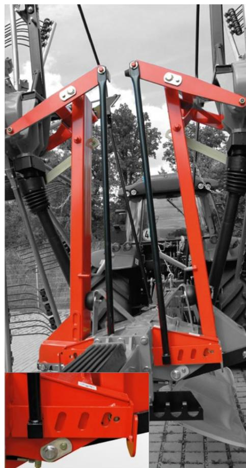
Réglage de la largeur de travail / largeur d'andain par sélecteur mécanique
