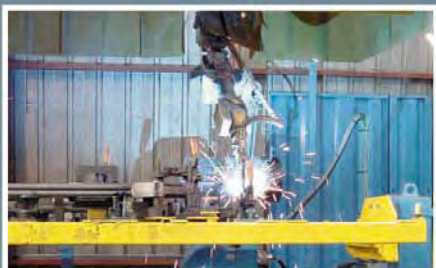
Robot de soudure des bras
