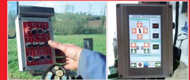
Die ergonomische Bedientafel, auch in drahtloser Ausführung verfügbar, vereint die Steuerung der Funktionen über ein CAN-Bus System.
