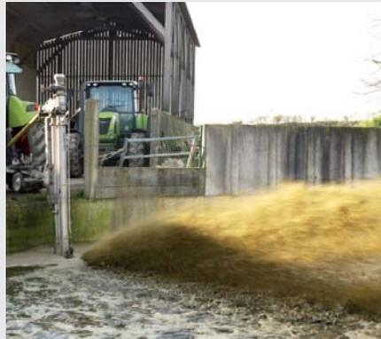
Angetrieben durch die Traktorzapfwelle, ermöglicht die Pumpe das Rühren in der Grube durch einen seitlichen Druckanschluss der Gülle. Die Düse ist horizontal und vertikal verstellbar, um sich zur Geometrie der Grube anzupassen. Wenn der Düsenschieber zu ist, wird die Gülle in Richtung des höheren Ausgangs angetrieben.
