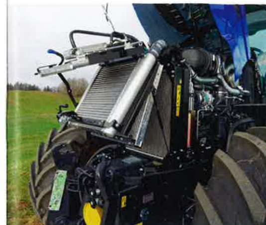
Le modèle «7-230» est doté d'un moteur turbo à 6 cylindres FPT développant 205 ch.
