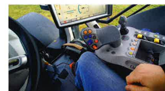
Les groupes et les rapports se changent via le levier multifonction de l'accoudeur.
