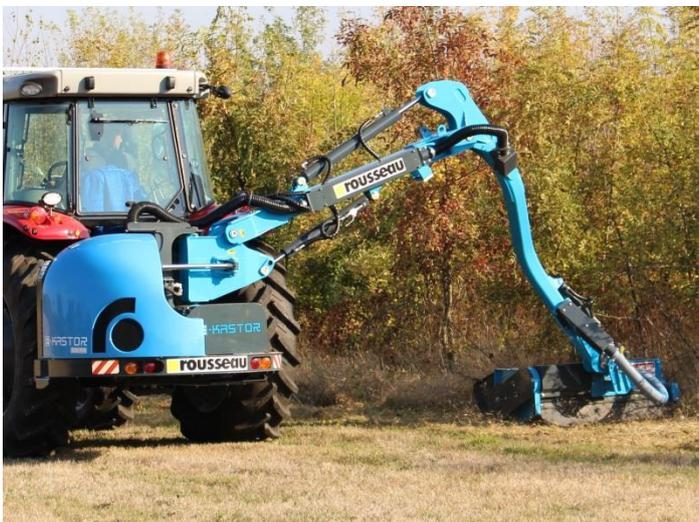
Der erste Böschungsmäher mit elektrischem Antrieb
