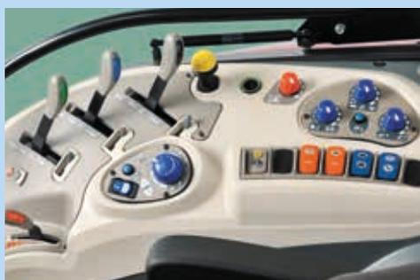
Le tracteur **6H** dispose de jusqu'à quatre distributeurs auxiliaires, dont trois sont contrôlés par des leviers mécaniques et le quatrième est commandé par un bouton-poussoir électro-hydraulique. Deux autres distributeurs ventraux sont disponibles en option pour l'actionnement d'autres outils, comme par exemple un chargeur frontal Série L.
