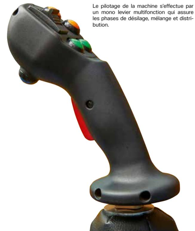
Le pilotage de la machine s'effectue par un mono levier multifonction qui assure les phases de désilage, mélange et distribution.
