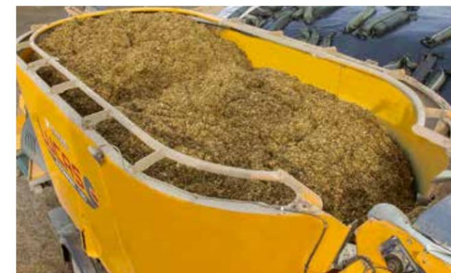
**Les vitesses de vis, la forme à palier et la cuve roulée forment un ensemble complémentaire garantissant un temps de mélange optimal et par conséquent, une consommation réduite à l'utilisation. La ration est prête à être distribuée le plus rapidement tout en respectant les matières premières.**
