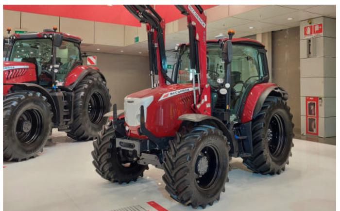
La série X5 se renouvelle avec les motorisations Stage V et se voit ainsi dotée de nouveaux moteurs FPT 4 cylindres de 3,6 litres de cylindrée, capables de délivrer jusqu'à 115 CV. Avec leur empattement de 2355 mm et leurs nombreux équipements, ces tracteurs sont idéaux pour travailler aussi bien à la ferme qu'au champ. Finalement, le **nouvel essieu avant suspendu** offre un niveau de confort et de sécurité optimal sur tous les terrains.
