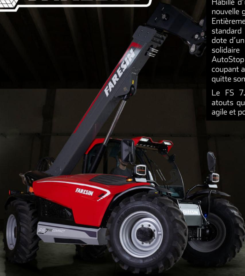
Habillé d'un design inédit, le FS 7.32 compact signe la nouvelle génération de chargeurs télescopiques Faresin. Entièrement revue, la cabine, disponible en version standard ou abaissée avec une hauteur de 2,05 m, se dote d'un écran tactile 7" et d'un joystick multifonction solidaire de l'accoudoir du siège. De plus, la fonction AutoStop promet des économies de carburant en coupant automatiquement le moteur lorsque l'opérateur quitte son siège, et le redémarrant à son retour.
