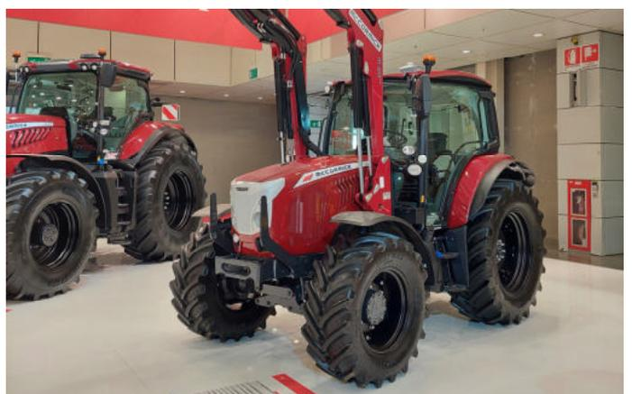
Die X5-Baureihe wird mit neuen 4-Zylinder-3,6-Liter-FPT-Motoren, die bis zu 115 PS leisten, auf Stufe V aufgerüstet. Mit einem Radstand von 2355 mm und einer breiten Ausstattungspalette sind diese Traktoren ideal für die Arbeit auf dem Hof und auf dem Feld. Schließlich bietet die neue gefederte Vorderachse optimalen Komfort und Sicherheit in jedem Gelände.
