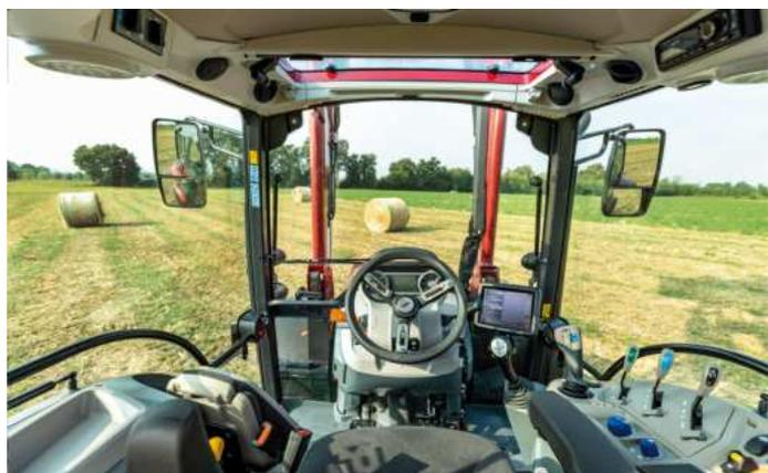
Ces modèles sont également équipés pour la première fois du système ADS (Advanced Driving System), qui permet d'éliminer tous les mouvements indésirables du volant causés par les irrégularités du terrain, réaligner automatiquement les roues après un virage et raidir la direction en fonction de la vitesse, offrant ainsi un confort de conduite exceptionnel. En plus de cela, l'essieu avant suspendu et la suspension de cabine garantissent un niveau élevé de confort.
