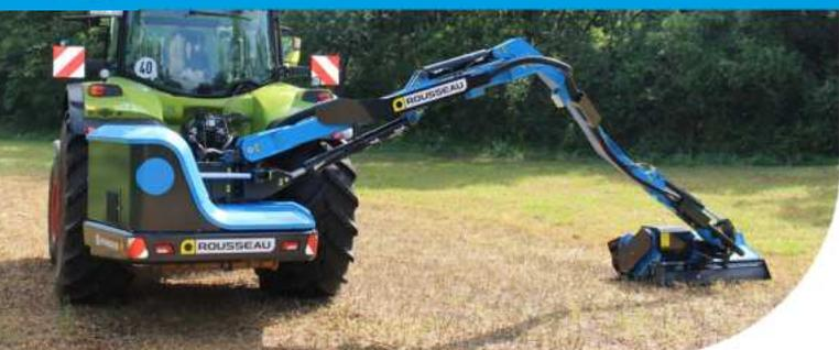
Sur les gammes E-Kastor, E-Kondor, E-Thenor et E-Fulgor, la transmission de puissance hydraulique a été remplacée par une transmission électrique pour l'entraînement du rotor. Cette nouvelle technologie brevetée présente de nombreux points forts tels que :
