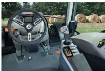
Accoudoir multifonction avec Joystick « *SmartPilot* »
