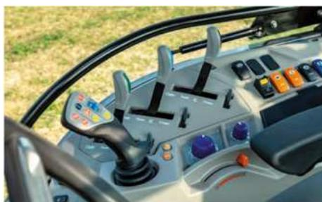
Transmission Roboshift avec joystick *SmartPilot*
