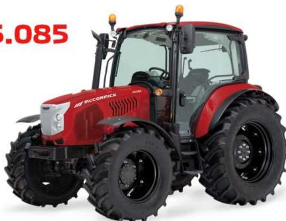
Puissance et technologie s'allient à la polyvalence et à la maniabilité dans le nouveau McCormick X5.085, notamment grâce au nouveau moteur FPT 4 cylindres de 3,4 litres, développant 75 CV et un couple de 375 Nm à 1'400 tr/min, le meilleur de sa catégorie, le rendant semblable à celui d'un tracteur de plus grande puissance. Le X5.085 offre également un grand choix de transmission, de la mécanique à la robotisée P3-Drive.
